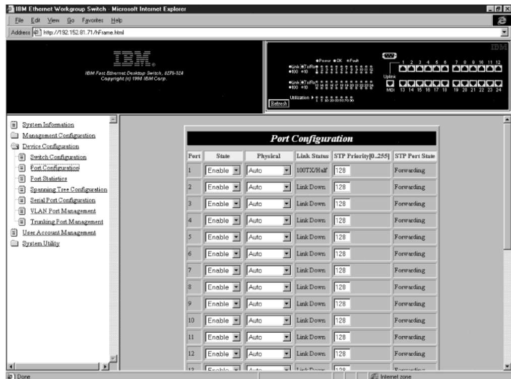
Abbildung 5-8. Anzeige "Port Configuration"
