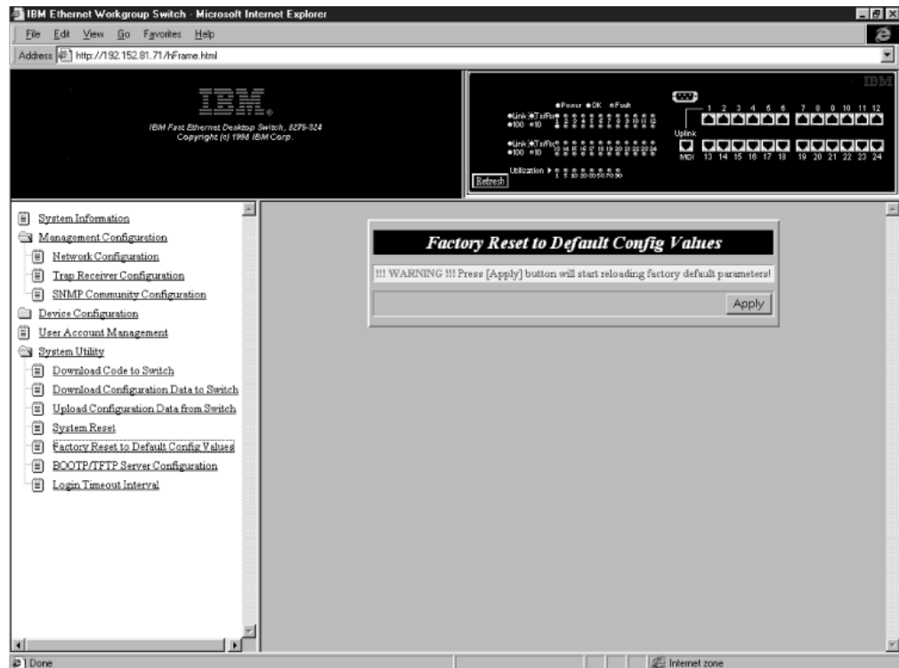
Abbildung 5-21. Anzeige "Factory Reset to Default Config Values"
